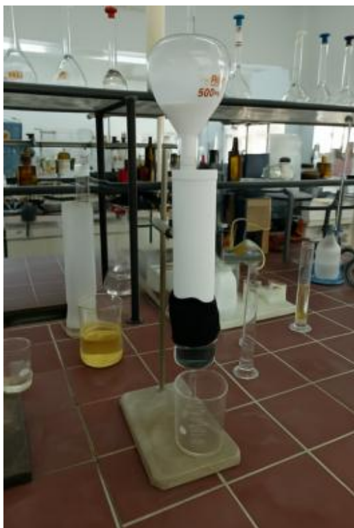
صورة توضح الطريقة المستخدمة لتقدير التوصيل الهيدروليكي للتربة.
